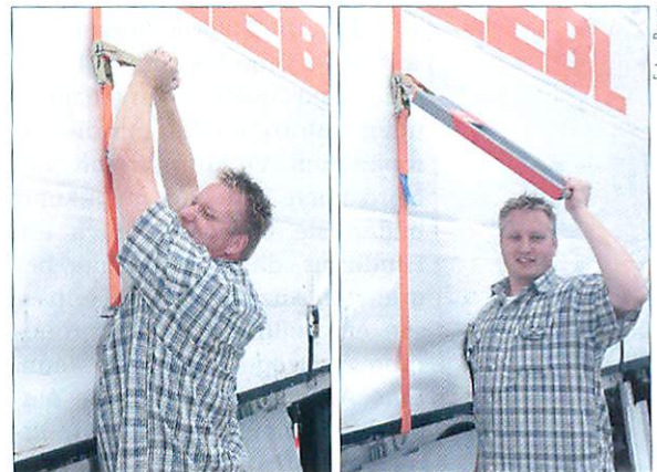
Um 50 daN Handkraft mit einer handelsüblichen Ratsche zu erreichen, sind hohe Kraftanstrengungen notwendig (links). Mit „SpannControl“ wird das Gurtspannen kinderleicht: Es werden nur 15 daN Handkraft benötigt (rechts).
