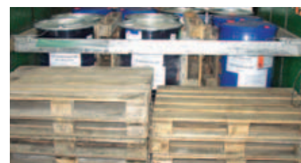
Leerpaletten füllen die Lücken zwischen den Fässern und hinter der Ladung bis zur Hecktür.
