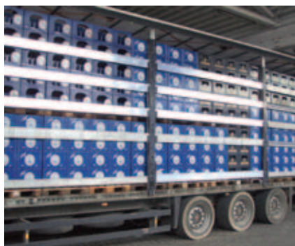
Formschlüssige Beladung eines für den Getränke-transport zertifizierten Curtainsiders
