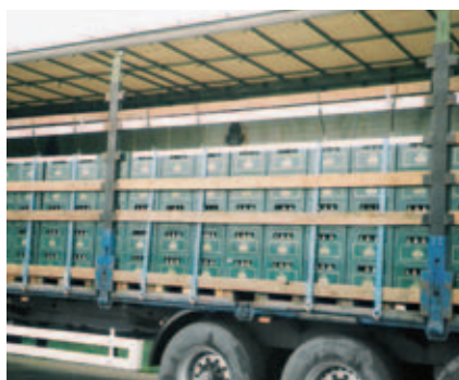
Ladungssicherung durch Niederzurren auf einem nicht zertifizierten Curtainsider
