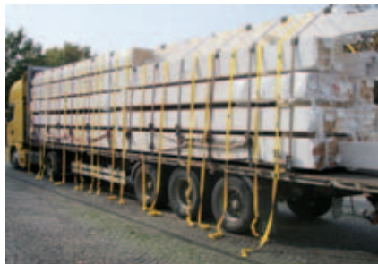
Wer eine schwere und glatte Ladung niederzurren will benötigt viele Zurrgurte.
