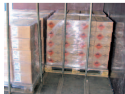
Sperrstangen zur rückwärtigen Ladungssicherung in einem Kofferverfahrzeug
