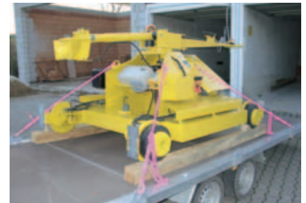
Sicherung durch Diagonalzurren (Foto RUD)
