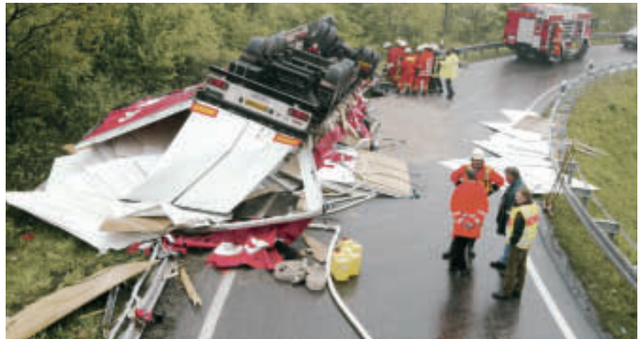
Die rutschenden Spanplatten entwickelten eine so große Kraft, dass dadurch der gesamte Sattelzug auf dem Dach landete. Foto: Lewandowski
