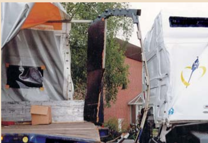
▲ Die Stirnwand des Sattelanhängers wurde herausgeschlagen.
