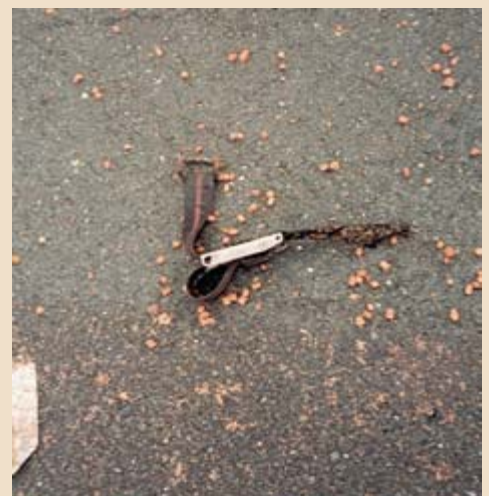
▼ Mehrere dieser Gurtverschlüsse lagen in der Kurve weit vor der Umsturzstelle.
