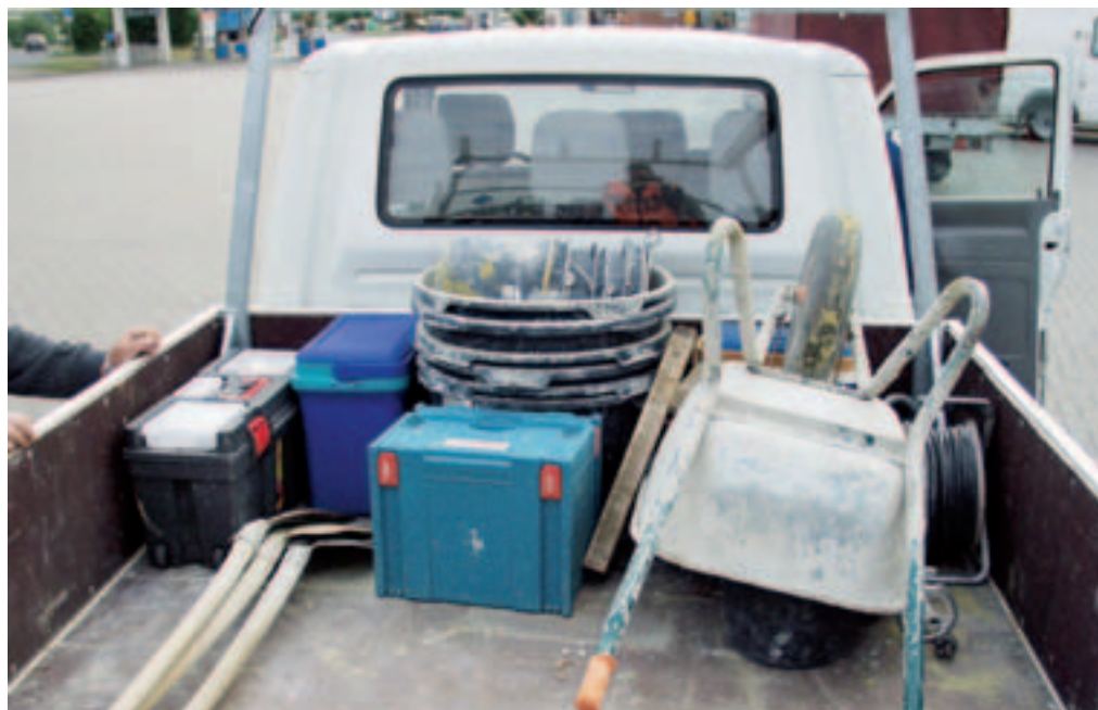
Diese Ladung ist gefährlich, denn auch eine Schubkarre kann vom Fahrtwind erfasst und auf die Autobahn geschleudert werden.
