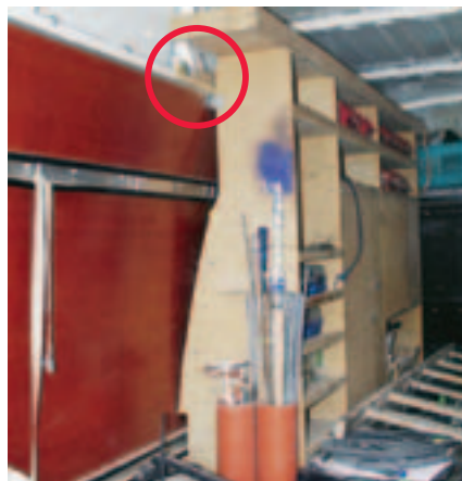
Dieses selbst gebaute Regal ist ungenügend am Fahrzeugaufbau befestigt (Kreis.)
