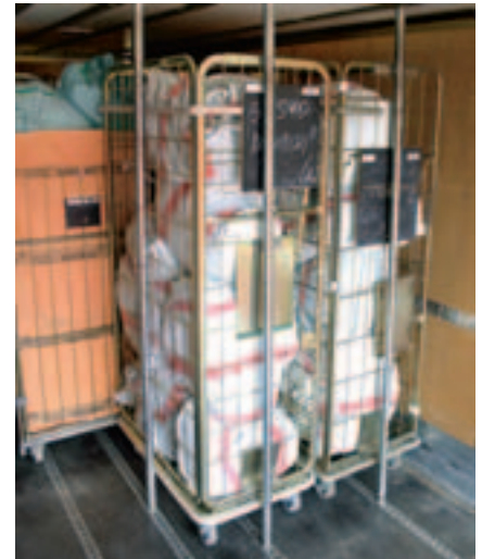
Sicherung von Rollcontainern durch Sperrstangen
