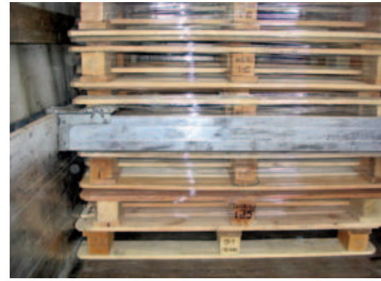
Klemmbalken haben nur eine geringe Sicherungskraft.
