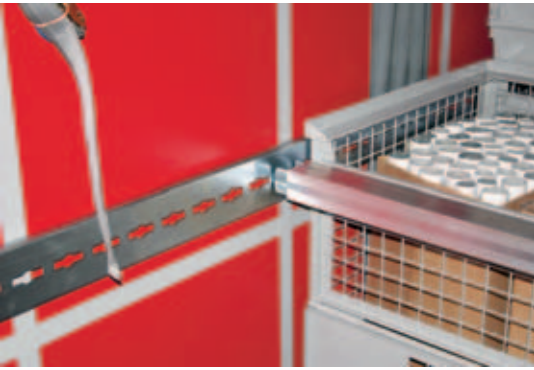
Sperrbalken werden in Ankerschienen eingerastet.
